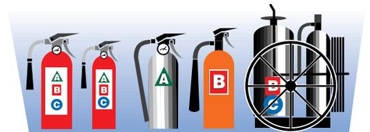
20 lb. 8 kg. 10 lb. 4 kg. Type à eau Type CO<sup>2</sup> Type sur roues
