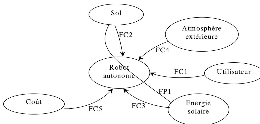
FP1 : Se déplacer en ligne droite sur le sol en utilisant l'énergie solaire.
