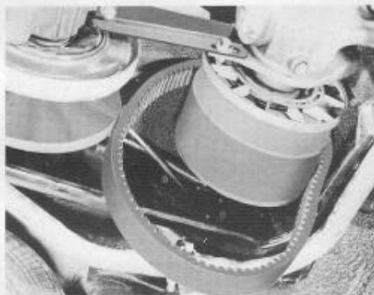
Introduire la courroie entre les flasques de la poulie motrice. L'on écarte les flasques de la poulie motrice en tirant la courroie. Ainsi l'on peut poser la courroie entre les flasques de la poulie réceptrice. La pose se poursuit dans l'ordre inverse de la dépose.
