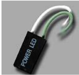
Exemple de connecteur de LED (vert="+" ; blanc="-")
