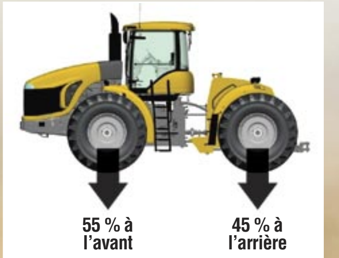
La répartition 55 % à l'avant et 45 % à l'arrière est la configuration de lestage la plus courante ; elle fournira des performances optimales pour la plupart des applications agricoles du MT900B.
