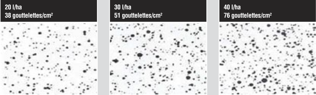
Fig. 2 : Densité des gouttelettes à un Diamètre médian du volume (DMV) de 300 µm.
