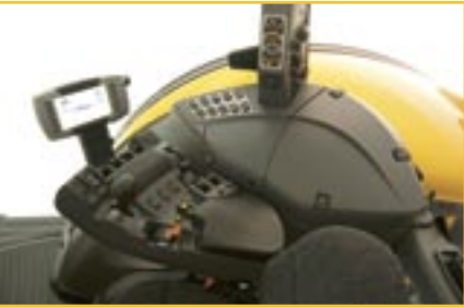
L'accoudoir ergonomique TMC inclut toutes les fonctions de contrôle tout près du siège.
