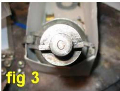
**C:** Assemblage symétrique de la pompe à huile avec l'arbre de commande. la figure 4 ci contre nous montre l'extrémité inférieure de l'arbre de commande. Le chanfrein à droite a certainement une raison d'être mais à ce jour inconnue.
