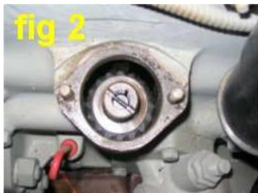
**B:** Engrenement du pignon claveté (visible sur la figure 2 ci dessus) de l'arbre de commande avec le pignon d'arbre à cames. (Taille hélicoïdale). C'est de là que part le mouvement vers le haut pour l'allumeur, vers le bas pour la pompe à huile.
