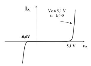
Une diode Zener se comporte comme une diode normale lorsqu'elle est polarisée en directe. Polarisée en inverse le courant reste nul jusqu'à ce que la tension soit inférieure à Vz puis cette tension, appelée tension zener, reste indépendante du courant. Cette diode est très utilisée pour la régulation des tensions.
